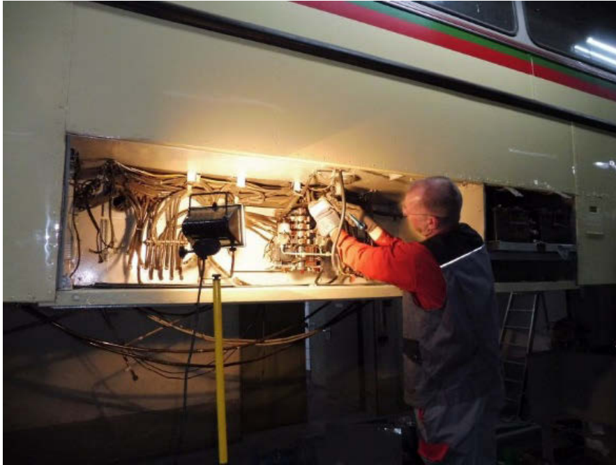
Jürgen Robben bearbeitet Kontaktstellen im Schützenfach, 19.5.2016
