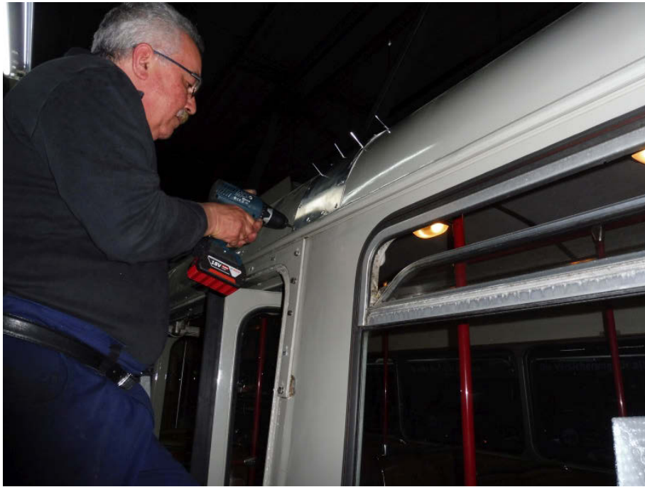
Werner Groszmuk beim Nieten der Dachhaut-Reparaturbleche, 12.3.2019
