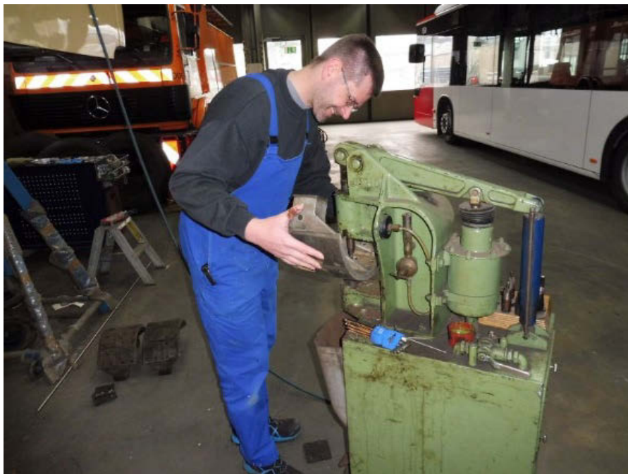
Sven Peters entfernt die Nieten der alten Bremsbeläge, 19.3.2016
