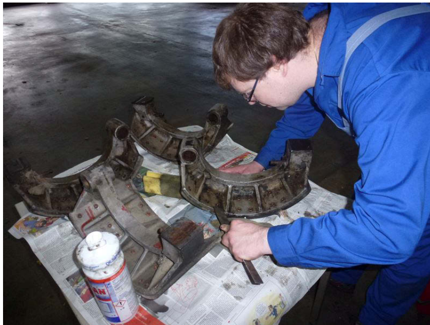
Sebastian Hailer beim Reinigen von Bremsbacken-Hälften, 5.9.2015
